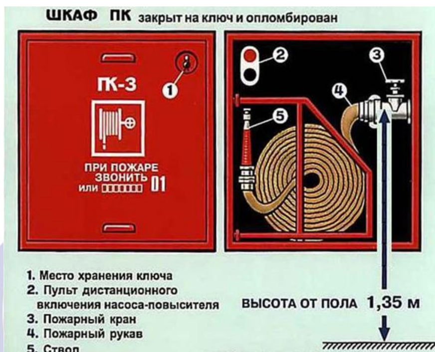
Рис. 13. Требования к размещению внутреннего пожарного крана.
