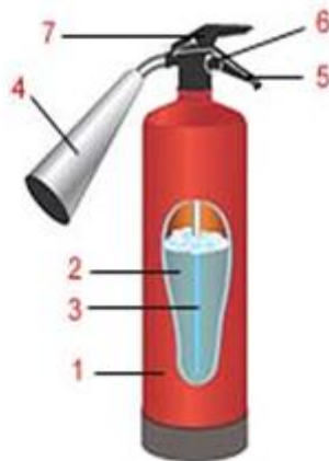
Рис. 8. Конструкция переносного углекислотного огнетушителя.
