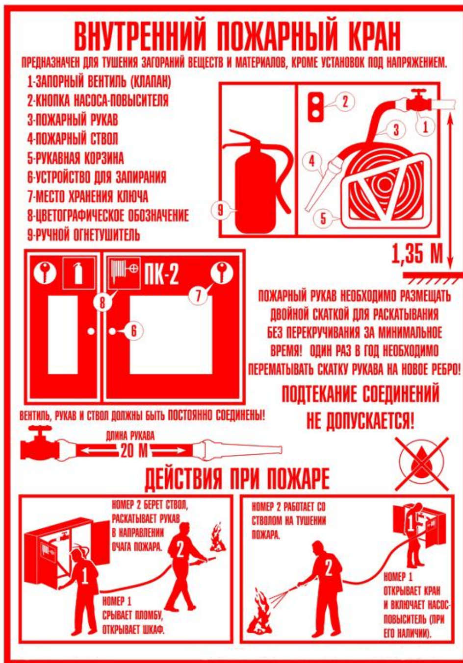
Рис. 4. Порядок применения внутреннего пожарного крана.
